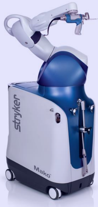
膝関節用ロボティックアームとナビゲーションシステム
